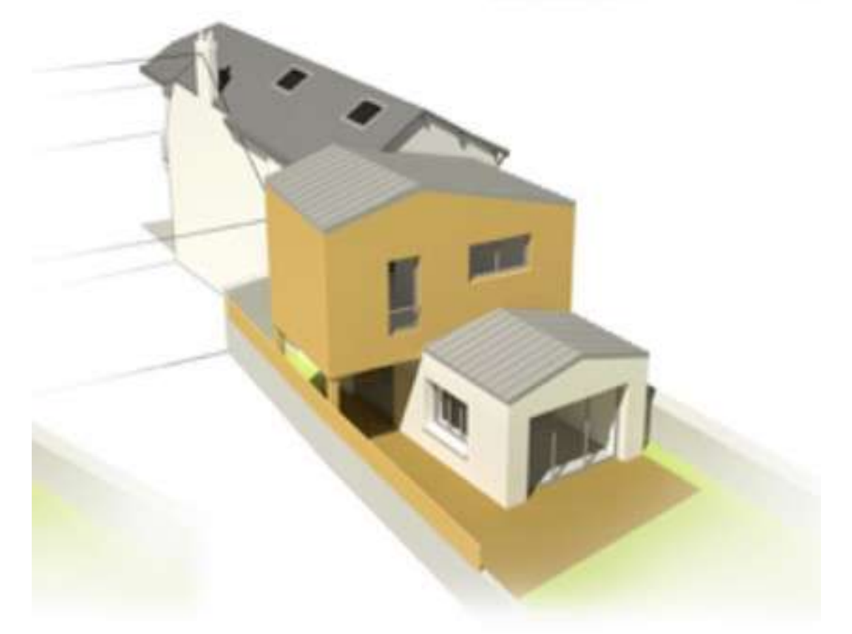
Extension limitée par surélévation sur construction existante
